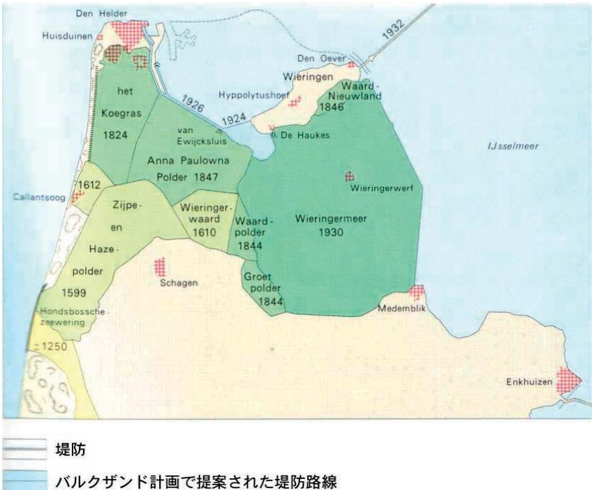
図9 西フリース海岸堤防北のゾイデル海の築堤状況
